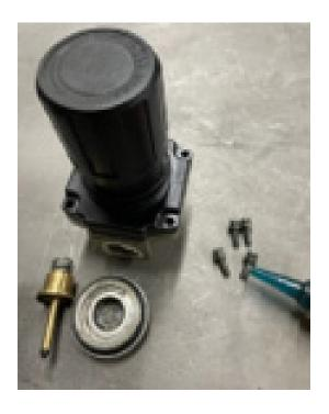
7. Retirez le capuchon arrière du régulateur pour supprimer toute tension ou pression sur le joint à membrane(diaphragme) pour le réassemblage.
