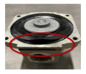
4. Installez le capuchon arrière du régulateur et réinstallez le régulateur sur le compresseur. Ajustez le régulateur a la pression désirée.
