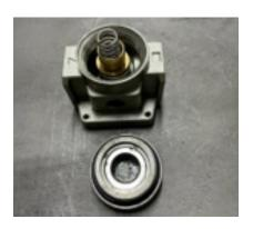
5. Placez le bouton de réglage sur le corps. Appliquez une colle de blocage amovible (ex. "loctite" bleu ) sur les vis et serrer.
